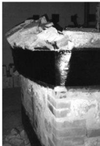
شکل ۲- کارایی لایه ی کامپوزیتهای پایه پلیمری (FRP) تا فروریختن دیوارهای آجری
