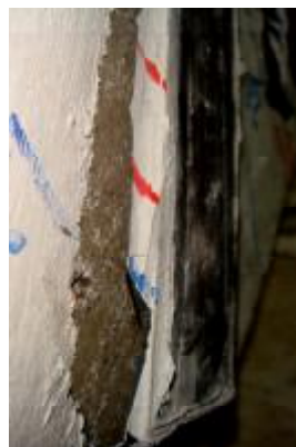
شکل 4- جدا شدن لامینیت از سطح بتن
