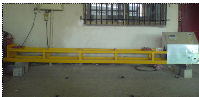
شکل 2- دستگاه پیش تنیدگی ورق FRP
